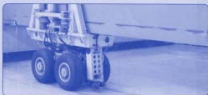
航空機荷重載荷装置
